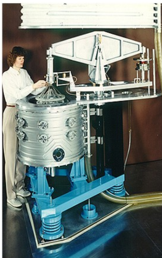
그림 2. 영국 국립물리연구소(NPL)에서 최초로 개발된 키블 저울. 현재 캐나다 국립연구회(NRC) 설치 운용
