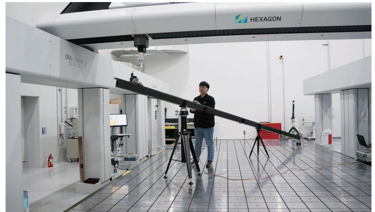
레이저 카본 레일 시스템을 이용해 초대형 접촉식측정기를 교정하는 모습
