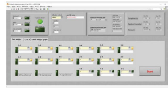
본 자동화 시스템의 기능을 살펴보면 18개의 분동 거치가 가능하도록 매거진을 설계 제작해 기준 분동 3개(5 kg, 10 kg, 20 kg) 이외에 15개의 교정대상 분동을 순차적으로 교정할 수 있다. 또한 분동 매거진과 로봇 손에 분동이 거치되어 있는지 유무를 확인할 수 있도록 하이버 센서를 삽입했으며, 저울(41 kg / 1 mg) weighing pan의 경우 감도분동을 거칠 수 있도록 제작해 저울의 감도 영향을 확인할 수 있다. 교정 반복 횟수의 선택, 3가지 분동 교정 알고리즘 선택과 측정 대기시간 입력이 가능하며, 공기밀도를 측정할 수 있도록 온도-상대습도-대기압 측정이 가능하다.
